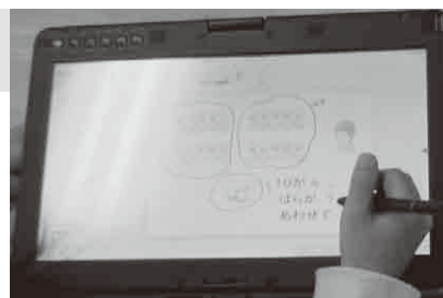
図9 タブレットPCの画面が反射している例
